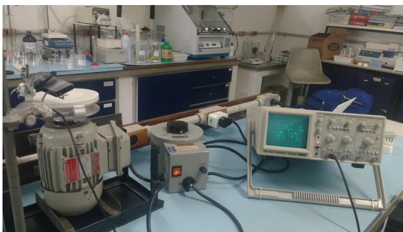
Figura 18 – Osciloscópio usado para medir a frequência de giro do motor e observar o comportamento da onda magnética resultante dos ímãs fixados nesse motor.
