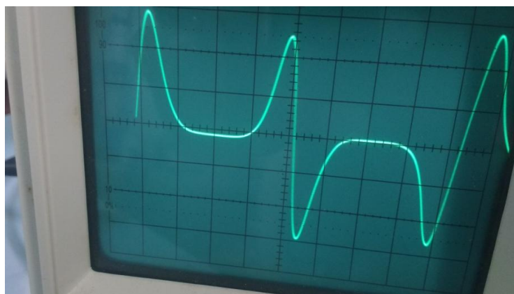
Figura 36 – Medidas do Osciloscópio do campo magnético gerado pelos ímãs que giram a frequência de 53Hz.
