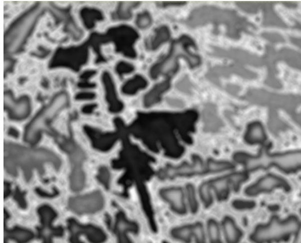
Figura 2.15 – Exemplo de aplicação do filtro linear de média. Adaptado de Eisenbeisser (2015).
