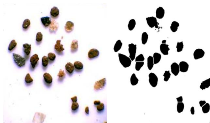
Figura 3.10 – Aplicação da técnica de threshold e análise dos minerais contidos na amostra. Fonte: BARBOSA, SILVA e MENDES (2014) .
