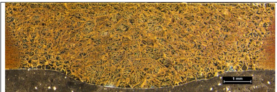
Condição 1 – Gás: Ar + 5%N; Pré-aquecimento: \sim 80^{\circ}\text{C} ; Energia de Soldagem: 0,59 kJ/mm
