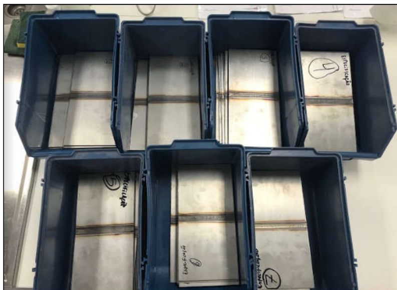
Figura 33 - Corpos de prova soldados pelo processo TIG autógeno.
