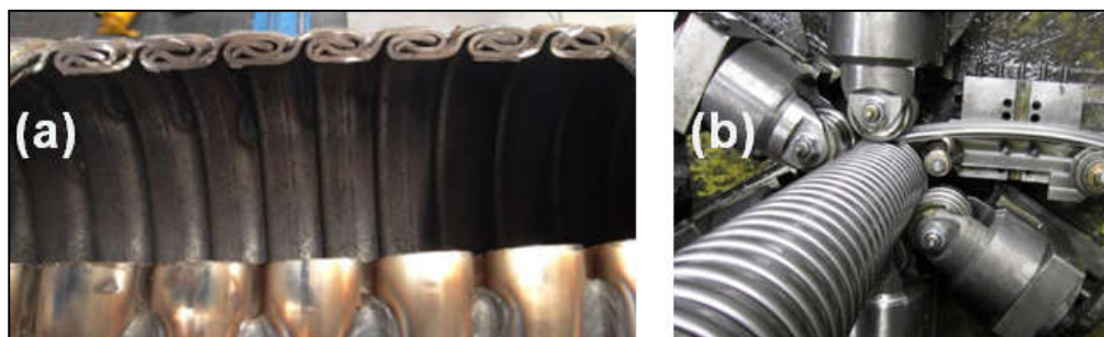
Figura 2 - Tubo de carcaça (a) após corte para remoção de amostra para análise de perfil ao início e final de produção e (b) máquina de fabricação de carcaça. Adaptado de Nielsen (2014).
