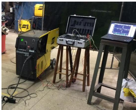
Figura 3.4: Equipamento SAP V4 acoplado a fonte de energia.
