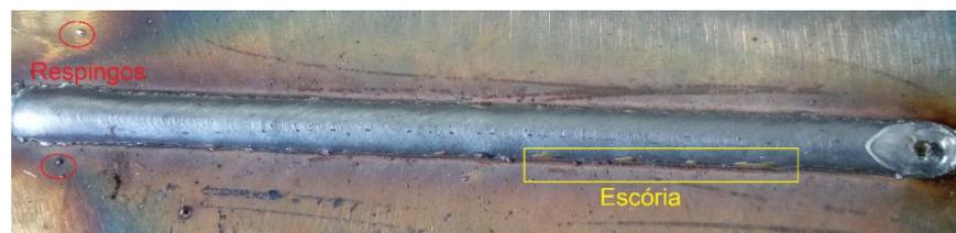
Figura 3.7: Respingos e escórias retidos na chapa e no cordão de solda.
