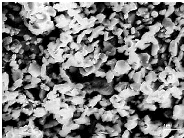
Figura 4.4: Micrografia do pó de \text{Al}_2\text{O}_3 . MEV. Aumento de 5000x.
