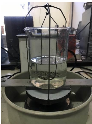
Figura 3.9: Aparato para Ensaio de determinação de densidade aparente pelo método de Arquimedes.
