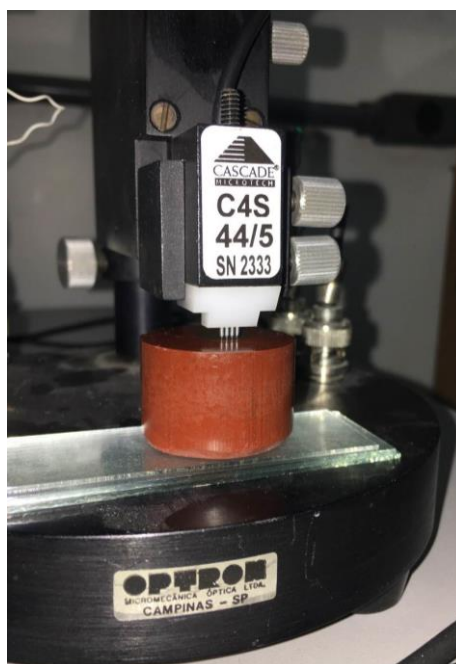
Figura 3.13: Visão ampliada do Sistema de ponteiros para medir a resistividade pelo método de 4 pontas colineares (LAMAV – UENF)
