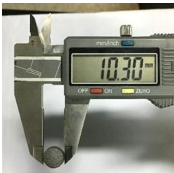
Figura 4.7: Análise dimensional de uma das pastilhas.
