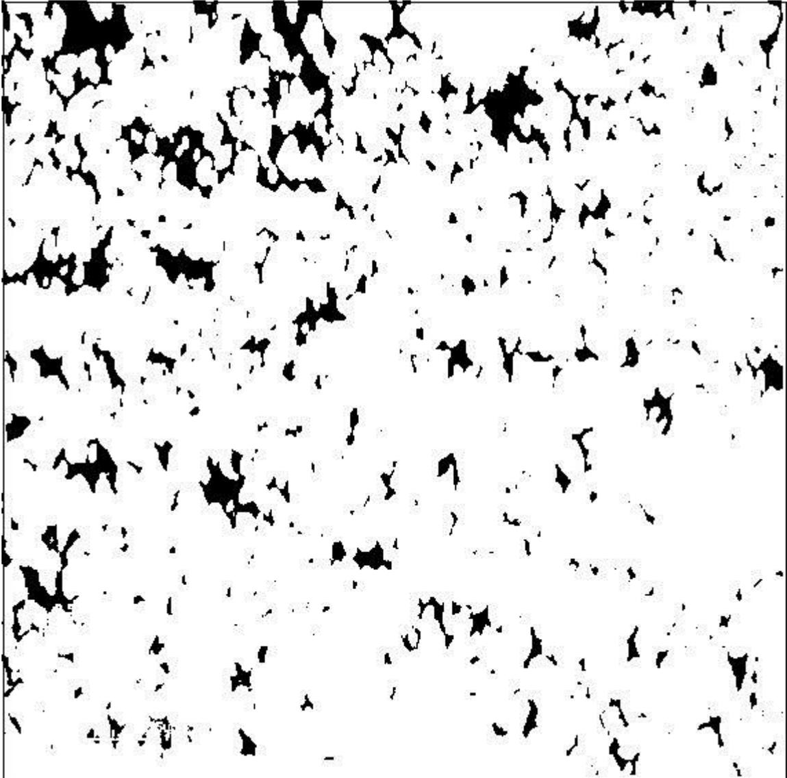
Figura 78 – Imagem binarizada processada por *software* da micrografia de seção transversal obtida por microscopia confocal com aumento de 17091x de filme de CFLE depositado a 450°C com fluxo de solução de 2,0 mL/min por 20 min sobre substrato de CDG.
