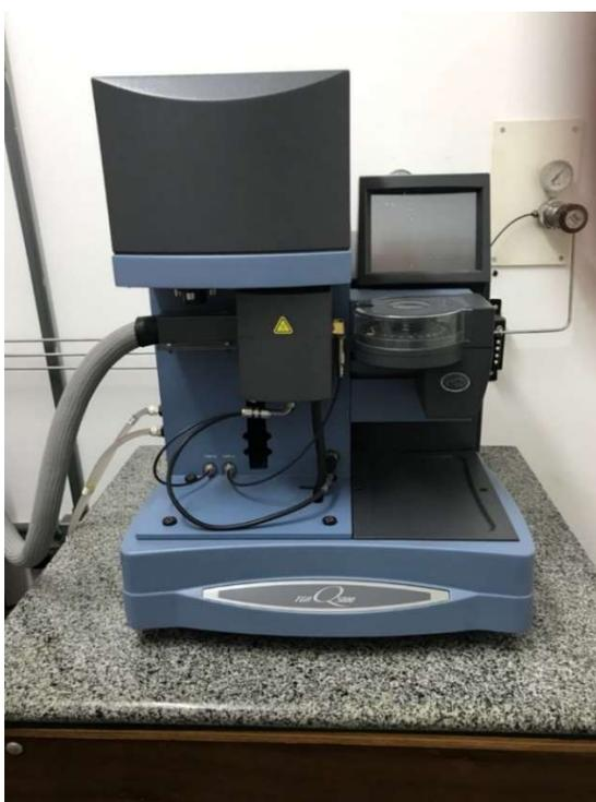
Figura 27 – Equipamento para análise de TGA.
