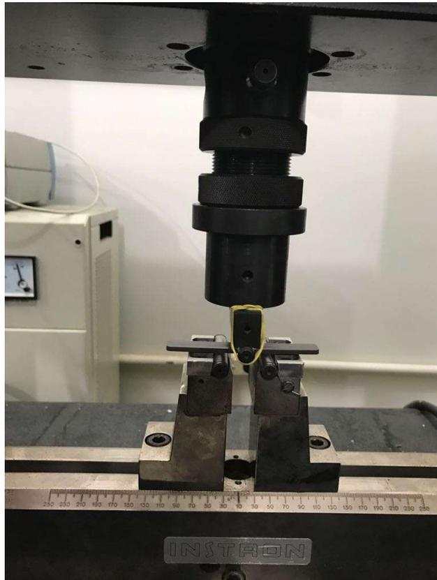
Figura 29 – Máquina Universal de Ensaio com a amostra durante o ensaio.
