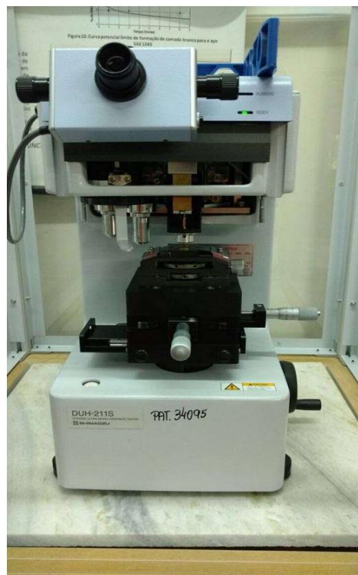
Figura 30 – Ultra-microdurômetro com a amostra durante o ensaio.
