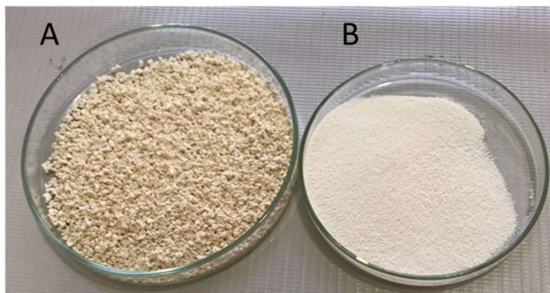
Figura 25 – Polímero antes (A) e após (B) o processo de purificação.
