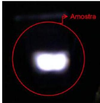
Figura 2.37 – Amostra do filme de alumina co-dopado 5% at. de cério, 1% at. de térbio e 1% at. de manganês depositado na temperatura de 300°C no fluorímetro sendo excitado em 300nm e irradiando luz branca (Henrique, 2014).
