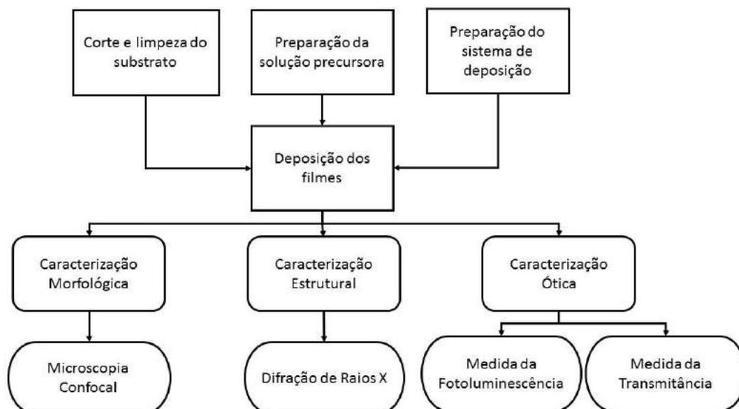
Figura 3.1 - Fluxograma da metodologia empregada para a produção e caracterização dos filmes de alumina intrínsecos, dopados e co-dopados com ativadores de luminescência depositados por spray-pirólise.
