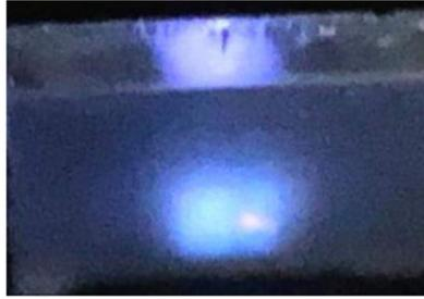
Figura 4.8 – Emissão do filme Al<sub>2</sub>O<sub>3</sub> dopado com 2% at. de Tm com T<sub>s</sub>= 300 °C.
