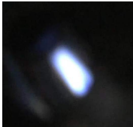
Figura 4.34 - Emissão do filme  $\text{Al}_2\text{O}_3:\text{Ce}:\text{Tb}:\text{Mn}$  depositado em 300 °C.
