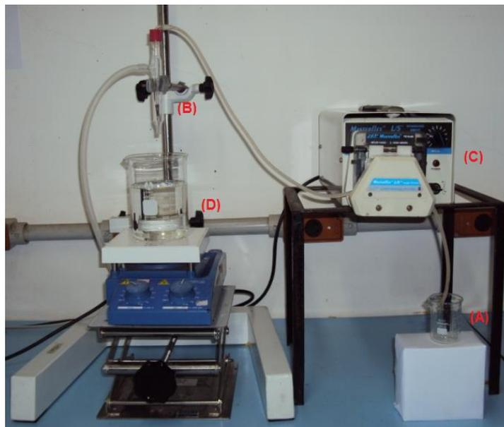
**Figura 23** – Esquema formulado para a técnica de coagulação.
