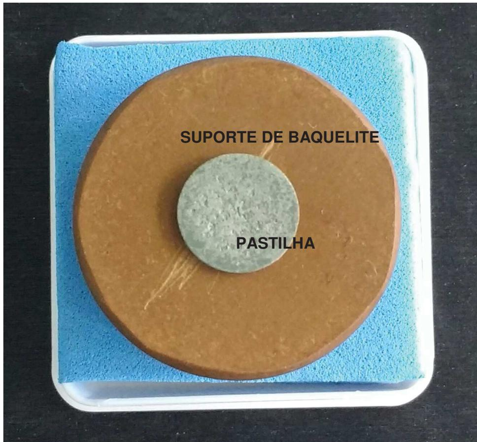
Figura 43- Ferramenta utilizada no processo de lixamento da pastilha de NiO-CDG.
