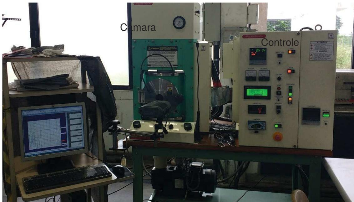
Figura 39- Equipamento de Sinterização por Plasma Pulsado Setor de Materiais Super Duros do LAMAV/UENF
