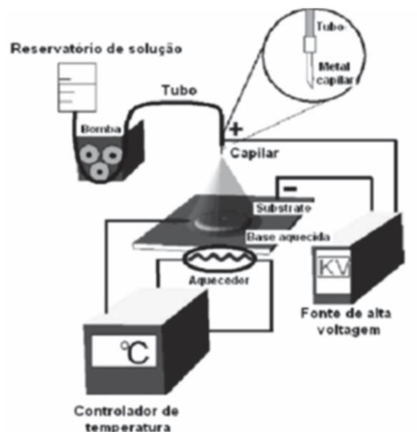
Figura 26- Sistema de deposição por spray eletrostático.
