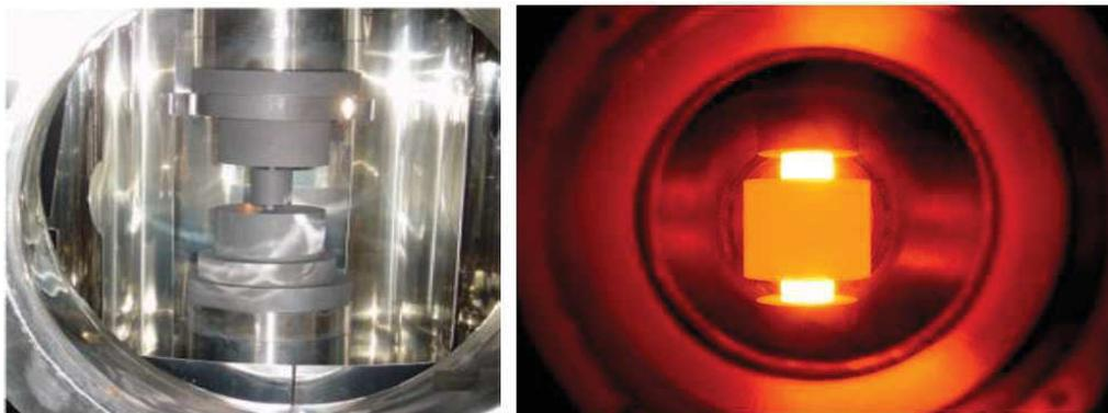
Figura 29- Matriz de grafite e pistões posicionados na câmara de vácuo, onde: (a) Câmara à vácuo de um equipamento SPS com matriz de grafite entre pistões (b) matriz e pistões aquecidos. Fonte: Ragulya (2010).
