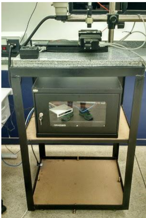
Figura 2.11 - Estrutura metálica construída com tampão de granito (Manhães, 2015).
