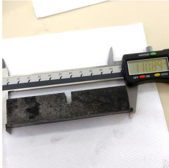
Figura 58-Paquímetro digital usado na medição das dimensões dos corpos de prova.
