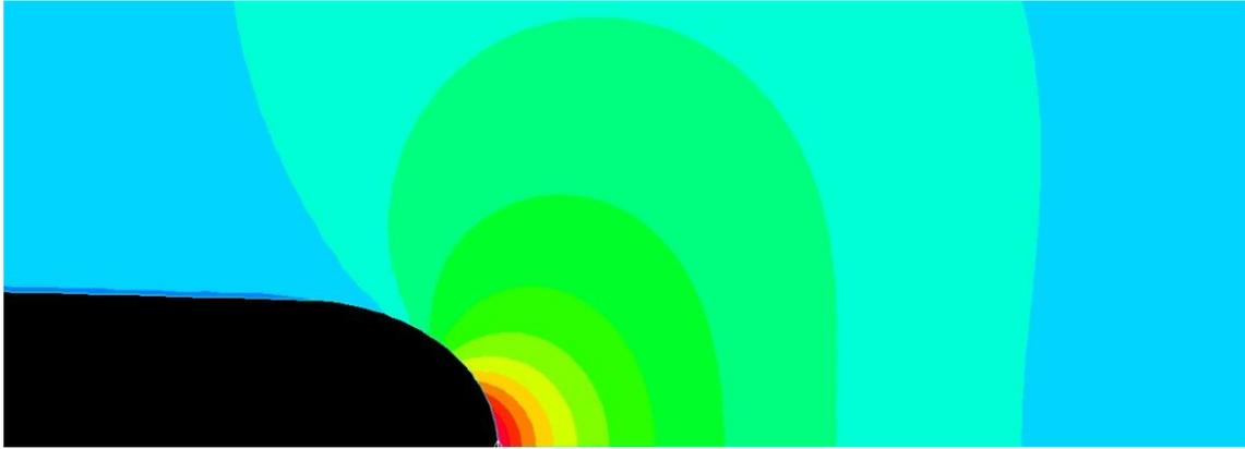
Figura 83-Campo de tensão nas vizinhanças do entalhe da amostra de eletroerosão (Carvalho, 2018).
