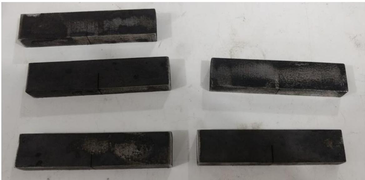
Figura 53-Amostras entalhadas por eletroerosão a fio.
