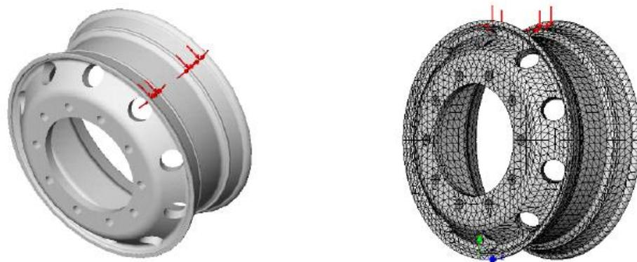
Figura 31-Modelo geométrico de uma polia (esquerda) e modelo discretizado por elementos finitos (direita). (Instituto ESSS, 2017).
