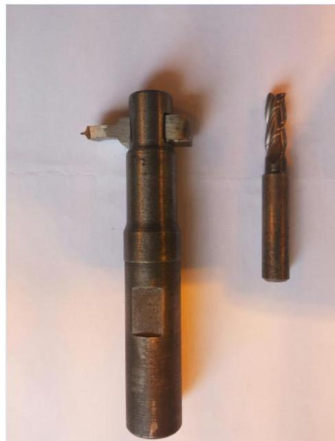
Figura 45- Ferramentas utilizadas para a inserção de entalhes em U de raio menor nos corpos de prova.
