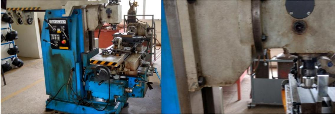
Figura 44-Fresadora utilizada na inserção do entalhe de raio maior.
