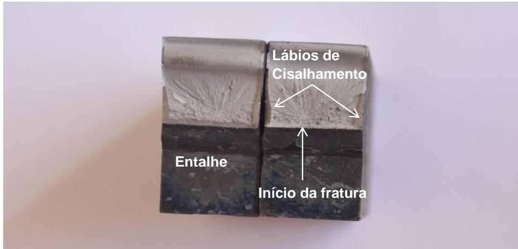
Figura 91-Aspecto macroscópico da superfície de fratura para o corpo de prova de raio maior.
