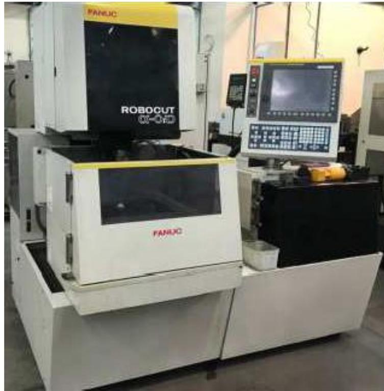
Figura 52-Equipamento utilizado para eletroerosão a fio nas amostras sem entalhes.
