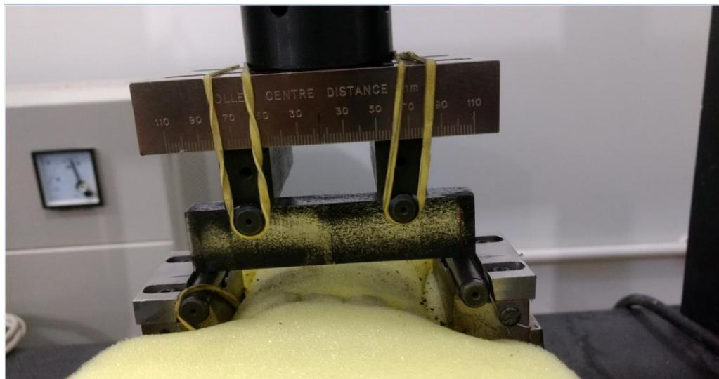
Figura 62-CP de eletroerosão preparado para ensaio de flexão em 4 pontos.
