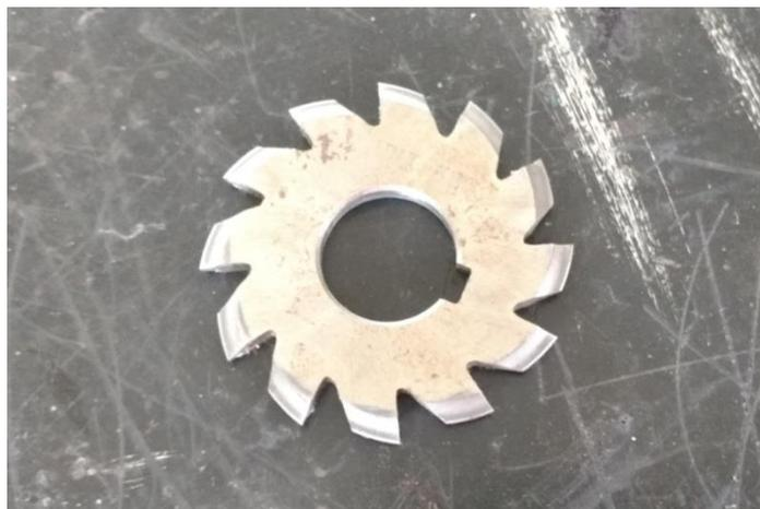
Figura 43-Fresa de módulo 1,5 e ângulo de pressão de  $20^\circ$ .
