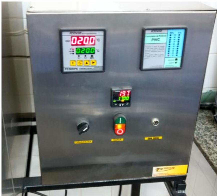
Figura 50-Forno para realização do revenimento.
