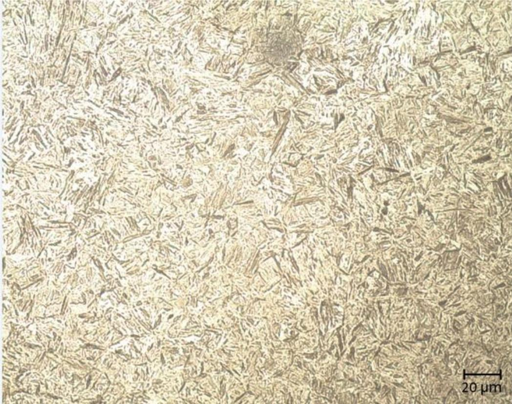
Figura 81-Microestrutura do aço AISI 4140 de eletroerosão temperado e revenido. Aumento de 500X.
