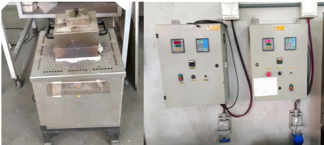
Figura 47-Forno utilizado na têmpera dos corpos de prova.
