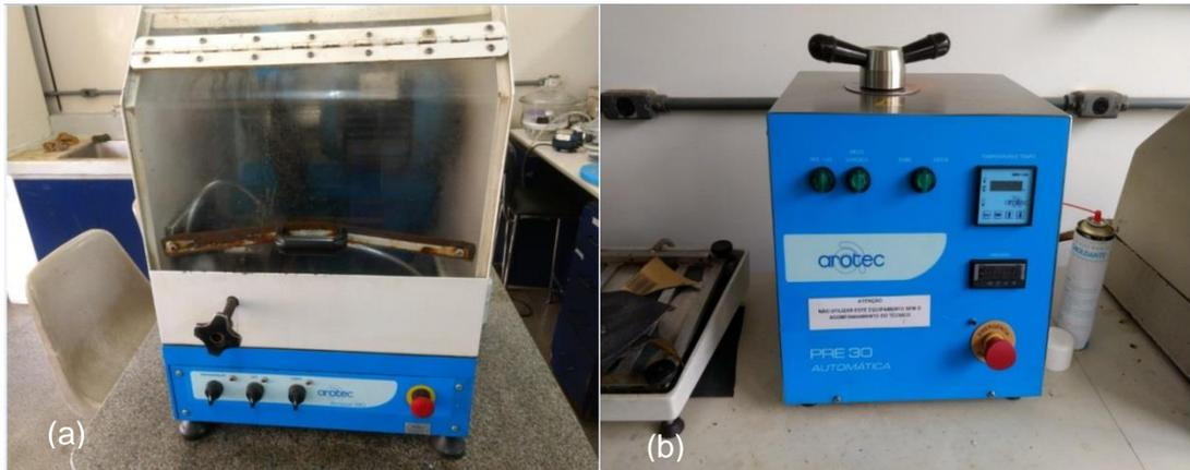
Figura 67-Equipamentos utilizados na preparação das amostras. (a) Policorte. (b) Embutidora a quente.
