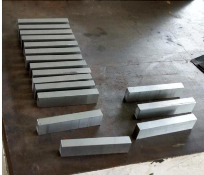
Figura 38-- Corpos de prova cortados em serra fita.
