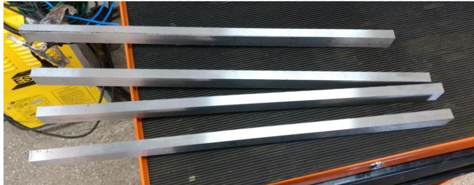
Figura 35-Barras retangulares do aço AISI 4140 com seção 25x13,7mm conforme recebido
