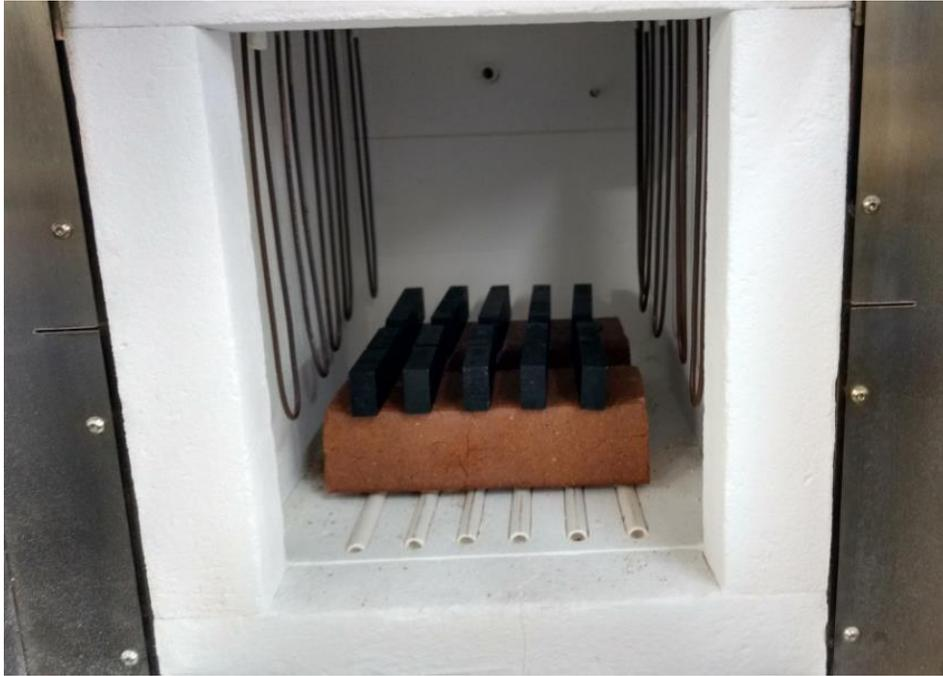
Figura 51-Corpos de prova no interior do forno para revenimento.
