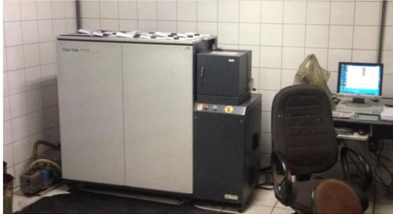
Figura 36-Espectômetro de emissão óptica modelo PDA-7000 da empresa TecnoSteel para realização das análises químicas.
