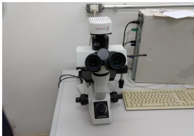
Figura 69-Microscópio óptico usado para caracterização estrutural dos corpos de prova.
