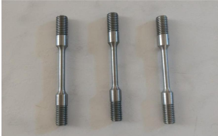
Figura 40-Corpos de prova para ensaio de tração.
