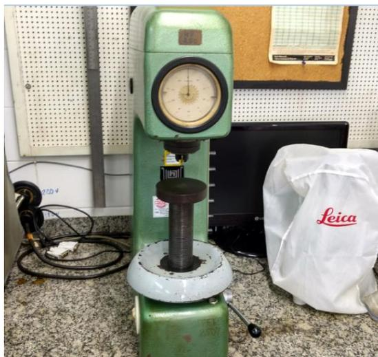
Figura 59-Durômetro Heickert para medição de dureza na escala Rockwel C no aço AISI 4140 após têmpera e revenimento.
