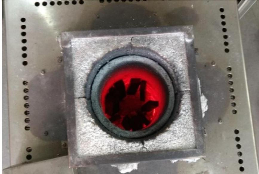
Figura 48-Corpos de prova no interior do forno.
