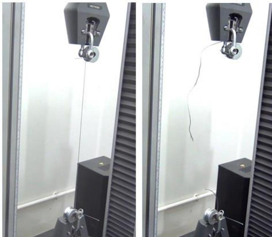
Figura 3.17 - Ensaio do cabo de aço feito em uma máquina INSTRON mostrando o cabo preso (esquerda) e seu rompimento (direita).
