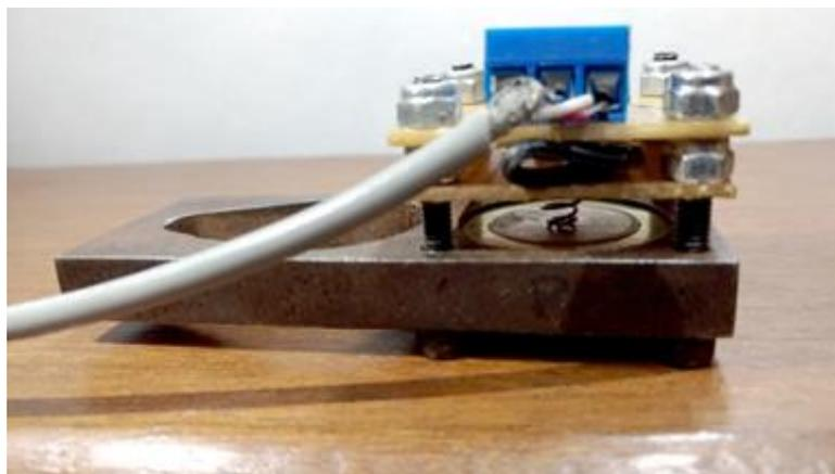
Figura 3.30 - Suporte para o captador piezoelétrico.
