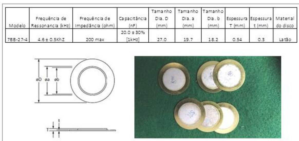
Figura 3.13 - Piezoelétrico.
