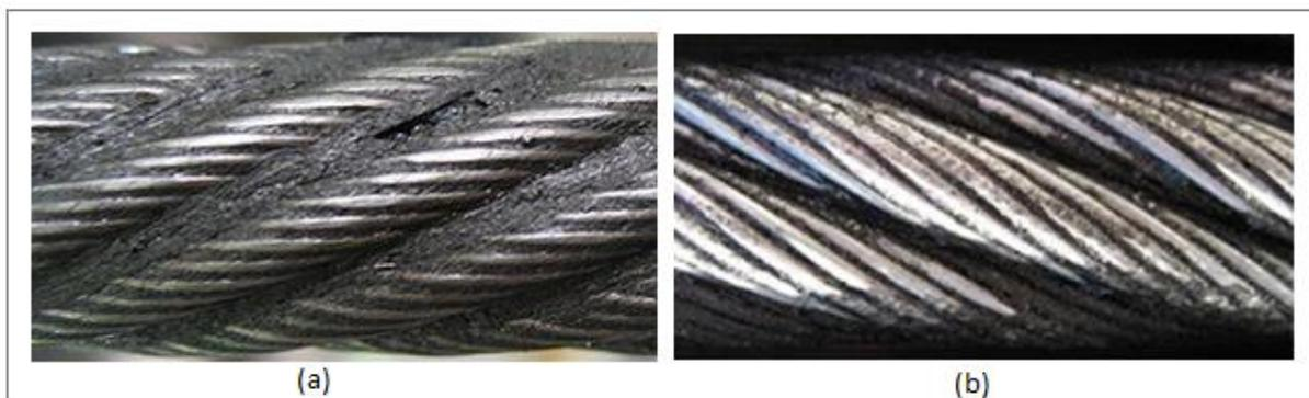
Figura 2.2 - (a) Torção à esquerda. (b) Torção à direita (CableMax, 2010).
