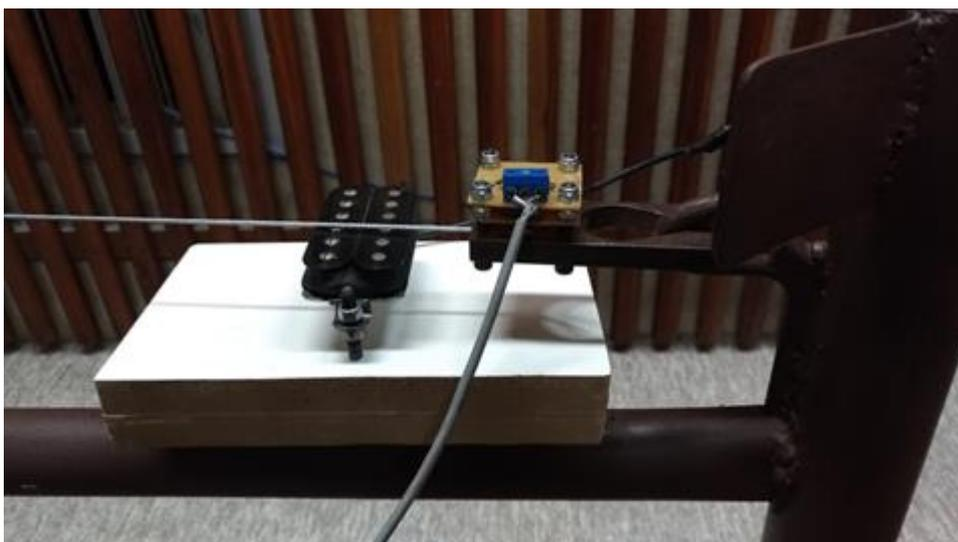
Figura 3.32 - Plataforma para captador magnético.
