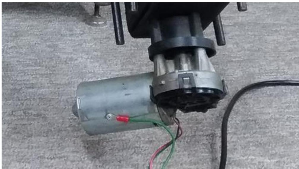
Figura 3.24 - Motor com sua caixa de redução.
