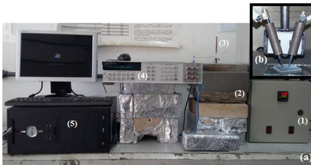
Figura 49: Sistema sensor de vapor de etanol: (a): (1) sistema controlador de temperatura (Rocha, 2017), (2) câmara do sensor, (3) seringa, (4) multímetro Agilent 3458A, (5) computador para aquisição automática de dados e (b) ponteiros do sistema de medição.
