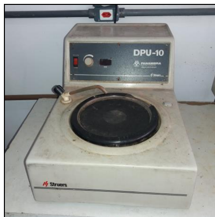
Figura 26 – Fotografia da Politriz disponível no laboratório de Metalografia/LAMAV.
