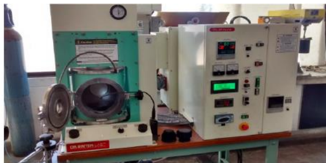
Figura 22 - Equipamento de Sinterização por Plasma Pulsado (SPS) – Disponível no setor de Materiais de Alta Dureza (LAMAV – UENF).
