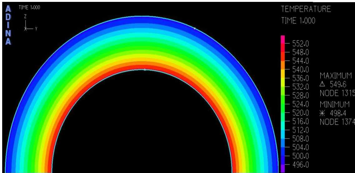
Figura 4.4: Ilustração da análise da distribuição de temperatura para tubo perfeito via MEF (convecção).
