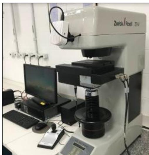
**Figura 38** - Durômetro Vickers Zwick Roell ZHV-10.
