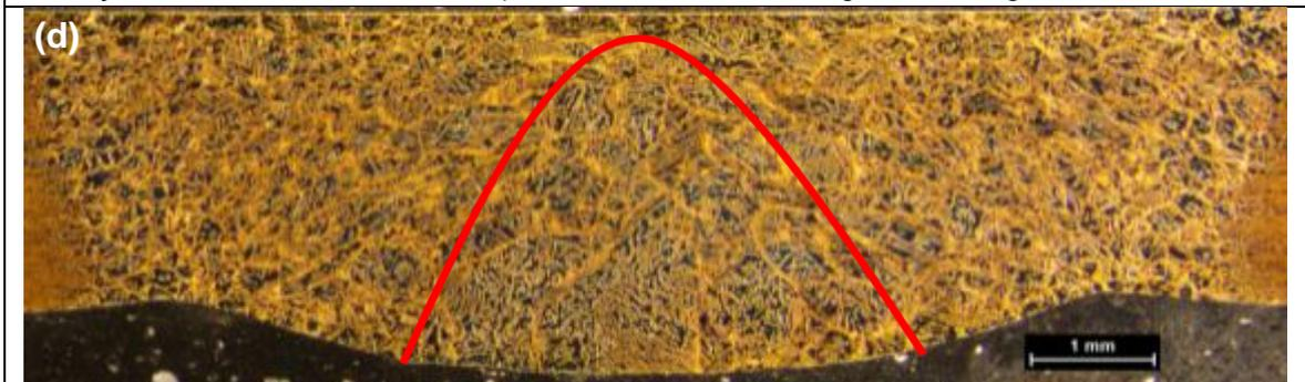
Condição 4 – Gás: Ar + 5%N; Pré-aquecimento:  $\sim 160^{\circ}\text{C}$ ; Energia de Soldagem: 0,59 kJ/mm
