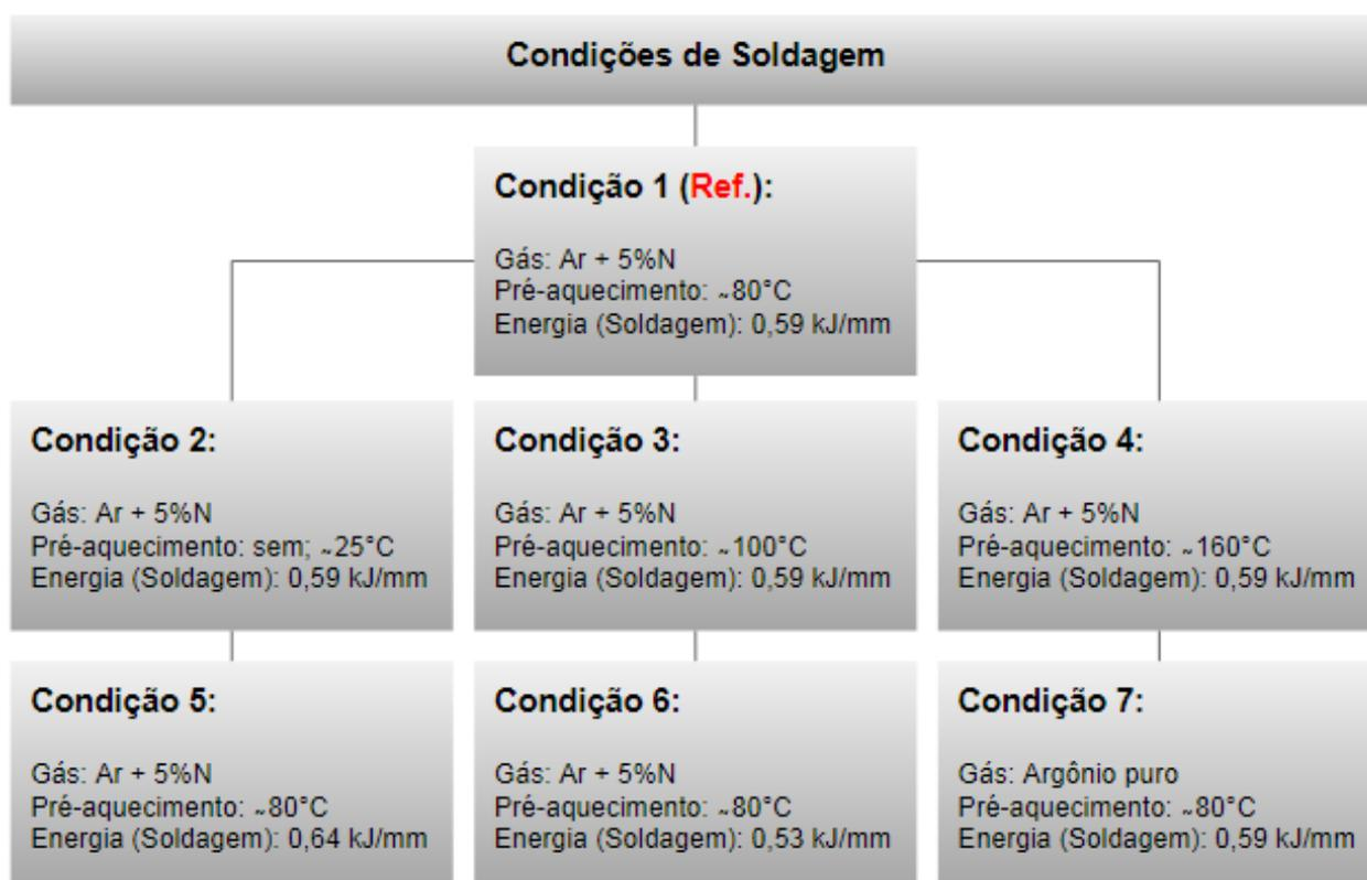
**Figura 32** - Condições de soldagem investigadas.
