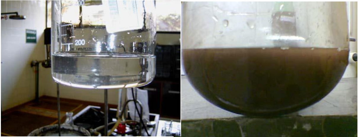
Figura 40. Claridade da água após filtragem. Na esquerda, utilizando o filtro cerâmico de ação capilar e na direita, o filtro de discos giratórios a vácuo (mais comumente encontrado na indústria).
