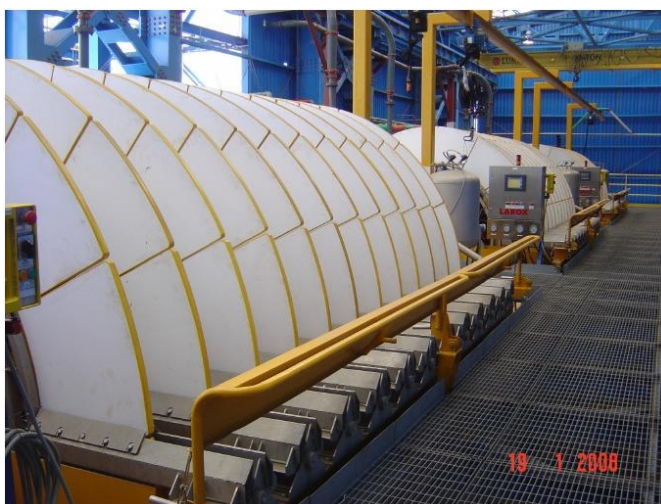
Figura 39. Filtros Ceramec. Fonte: ANGLO, 2011b.
