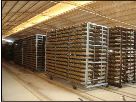
**Figura 4.13:** Galpão de secagem das telhas.
