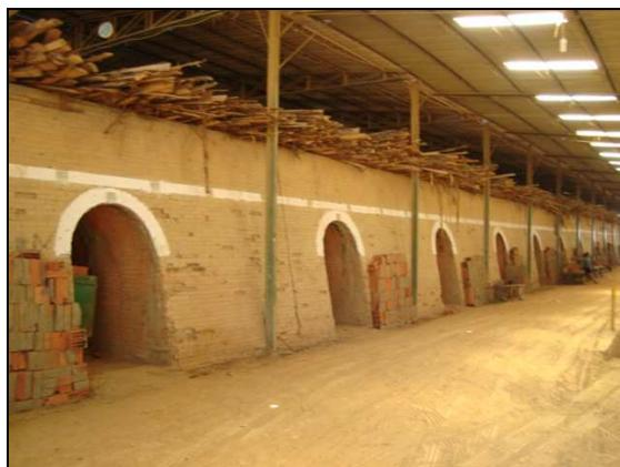
**Figura 4.14:** Forno do tipo Hoffman utilizado na queima de tijolos.
