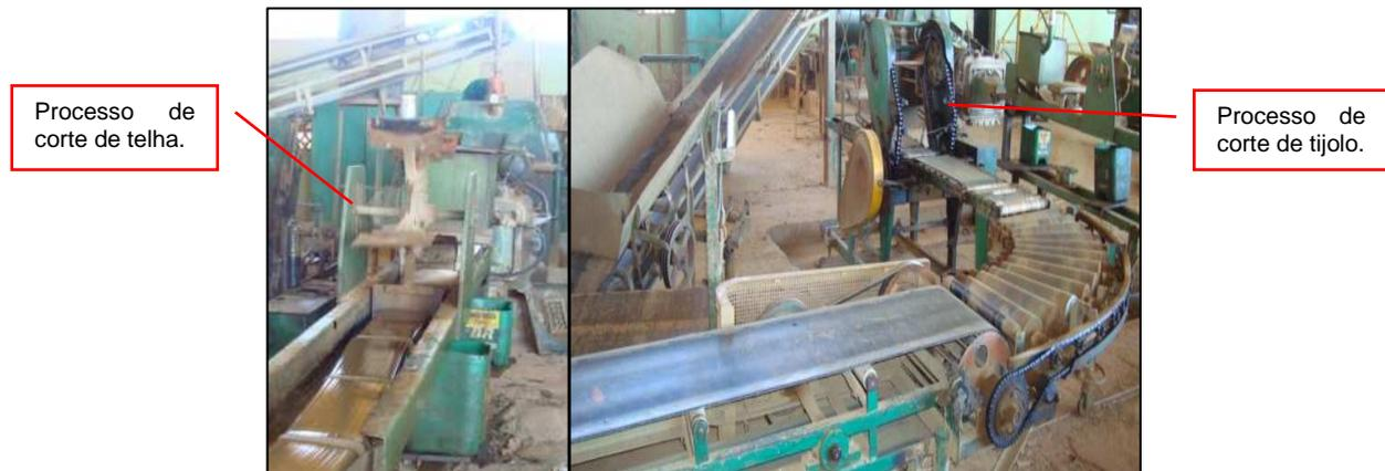
**Figura 4.10:** Foto das máquinas de corte.
