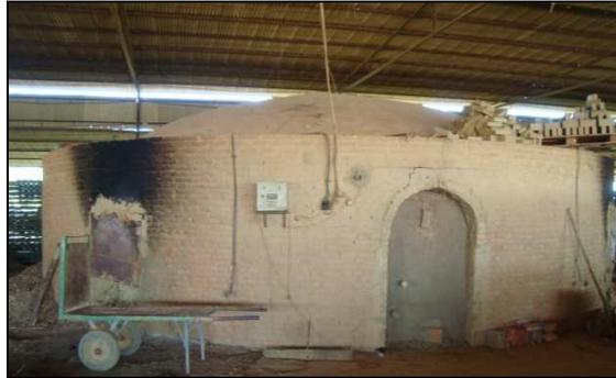
**Figura 4.15:** Forno utilizado na queima de telhas.
