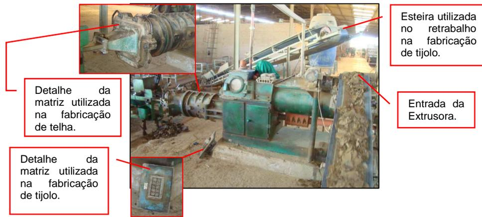
**Figura 4.9:** Foto do processo de Extrusão.
