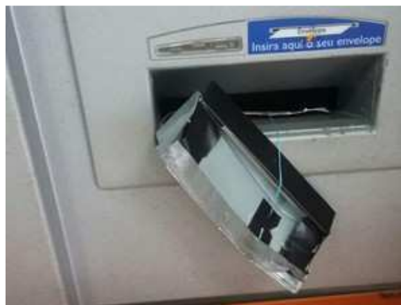
Figura 3.2 - O golpe do "chupa-cabra" em terminais eletrônicos
