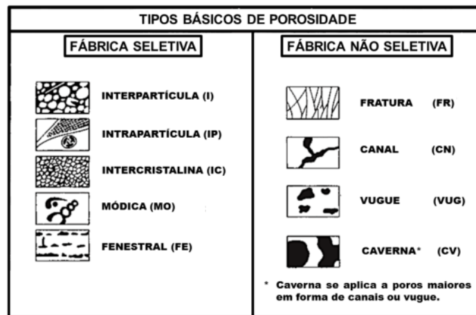
Figura 3 – Tipos básicos da classificação de porosidade segundo Choquette & Pray (1970) para carbonatos. Essa classificação se baseia no tipo de poro da rocha com o tipo de fábrica. Observe que a fábrica da rocha inclui fábricas tanto deposicionais quanto diagenéticas. Adaptado de Choquette & Pray (1970).
