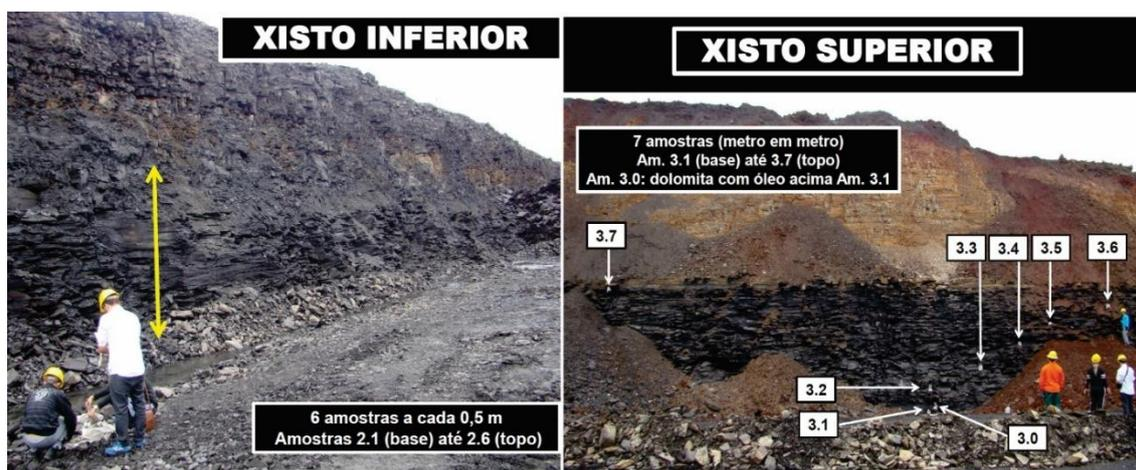
Figura 24. Afloramentos da pedreira da SIX, em São Mateus do Sul (PR), onde foram coletadas seis amostras da Formação Irati na camada de folhelho inferior (SM 2.1 a 2.6; esquerda) e sete amostras na camada de folhelho superior (SM 3.1 a 3.7; direita). Fotografia cedida pelo professor Severiano Ribeiro.
