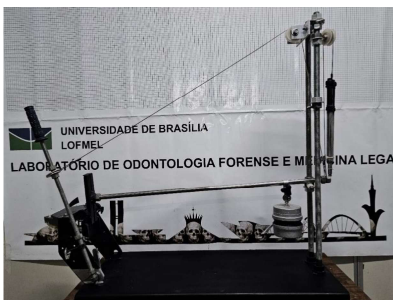
Figura 4. Vista lateral do aparelho utilizado para ensaio de mordida. Fonte: arquivo pessoal (2024)
