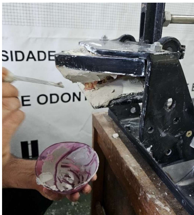
Figura 9. Fixação dos modelos mandibular e maxilar na extremidade móvel da haste superior com auxílio de uma placa de apoio metálica, também ajustada com gesso e mantida por um elástico de borracha. Fonte: arquivo pessoal (2025).
