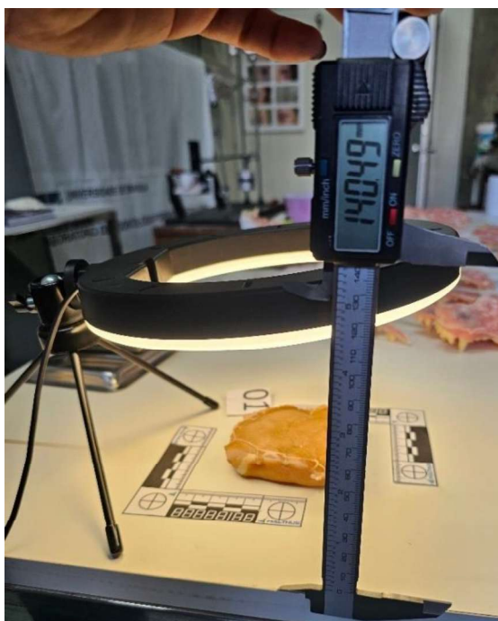
Figura 12. Posicionamento do Iluminador Ring Light 6 polegadas 36 led usb led misto, à 14cm da mesa. Fonte: arquivo pessoal da autora (2025).
