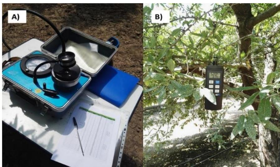
**Figura 3. Avaliação do potencial hídrico em folha sombreada por meio da câmara de pressão (Schlander et al, 1965) (A). Umidade relativa/temperatura do ar por meio do termohigrômetro portátil (B).**
