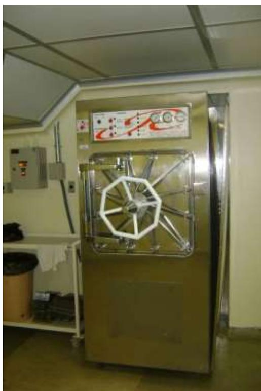
Figura 4. Biotério de experimentação. Sala de lavagem e esterilização de água, ração e maravalha. Na imagem autoclave de dupla porta.
