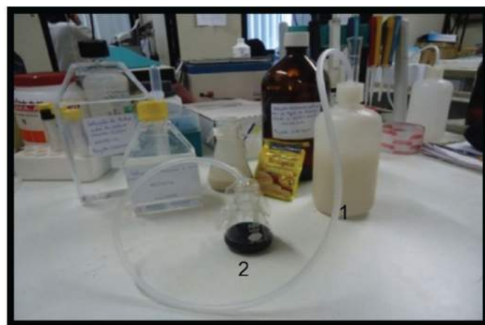
Figura 08: Exemplo de teste realizado com o experimento: Fermentação Alcoólica. Teste feito para a visualização da liberação de CO 2 durante a fermentação que faz a solução de azul de bromotimol que está em estado básico para estado ácido.
