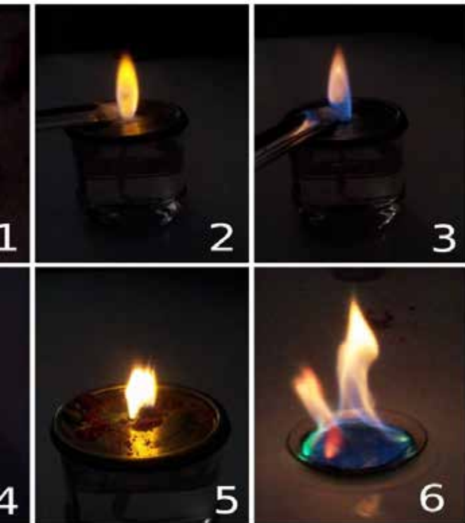
Figura 5- Coloração das chamas do teste de chama dos respectivos sais: \text{SrCl}_2 , \text{NaCl} , \text{CuSO}_4 \cdot 5\text{H}_2\text{O} , \text{BaCl}_2 , \text{CoCl}_2 e todos os sais juntos. Fonte: Própria
