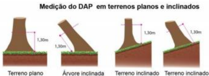
Figura 4: Orientações para medição de Diâmetro na Altura do Peito. Fonte: retirado de Manual de Campo do Inventário Florestal Nacional, 2019.
