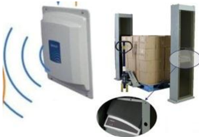
Figura 15 – Antena e Portal RFID a serem instalados
