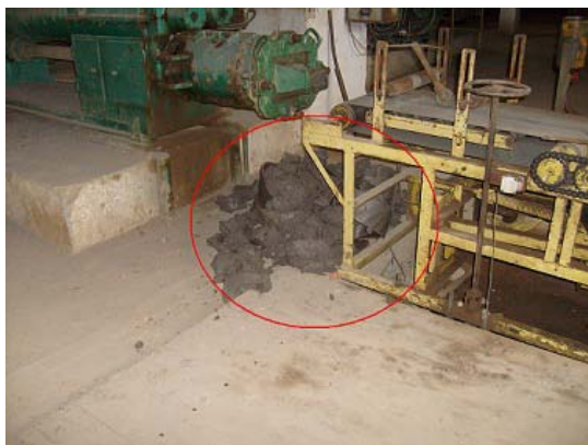
Figura 33 - Detalhe matéria-prima extrudada com problemas
