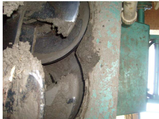
Figura 12 - Detalhe da massa sendo empurrada p/ câmara de vácuo
