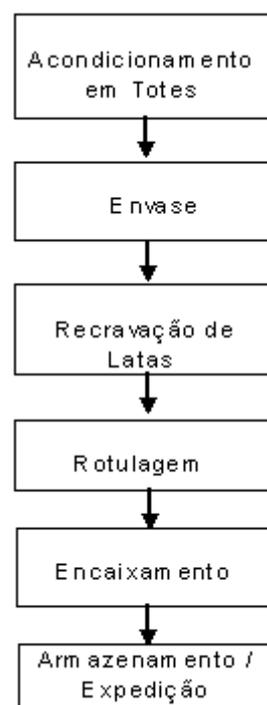
Figura 6 - Fluxograma de Enlatamento do Leite em Pó
