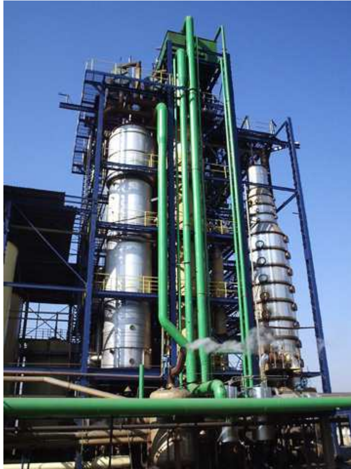
Figura 3 – Etapa de destilação para fabricação de álcool
