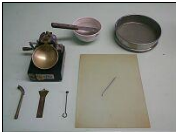
Figura 8: Equipamentos para a determinação do limite de liquidez e plasticidade da massa argilosa. Fonte: http://www.geotecnia.ufba.br/imagens/equipamentos/Limite%20de%20Liquidez.jpg
