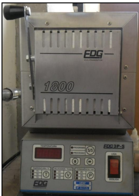
Figura 10: Forno elétrico tipo mufla para queima dos corpos cerâmicos. Fonte:Próprio autor.
