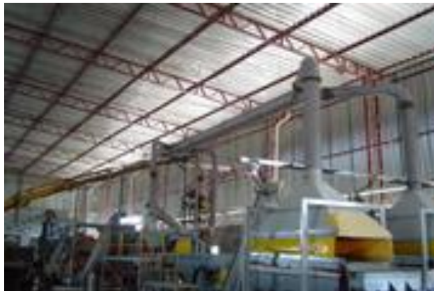
Figura 9 – Sistema de aspiração. FONTE: PORTAL DA RECICLA 10 (2012) (b).
