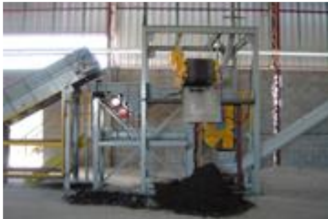
Figura 8 – Separador magnético do aço: Overbelt . FONTE: PORTAL DA RECICLA 10 (2012) (b)
