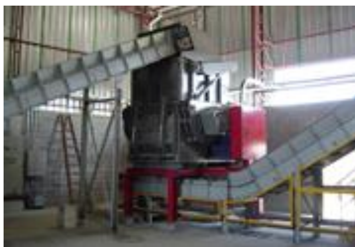
Figura 7- Calha Vibratória. FONTE: PORTAL DA RECICLA 10 (2012) (b).
