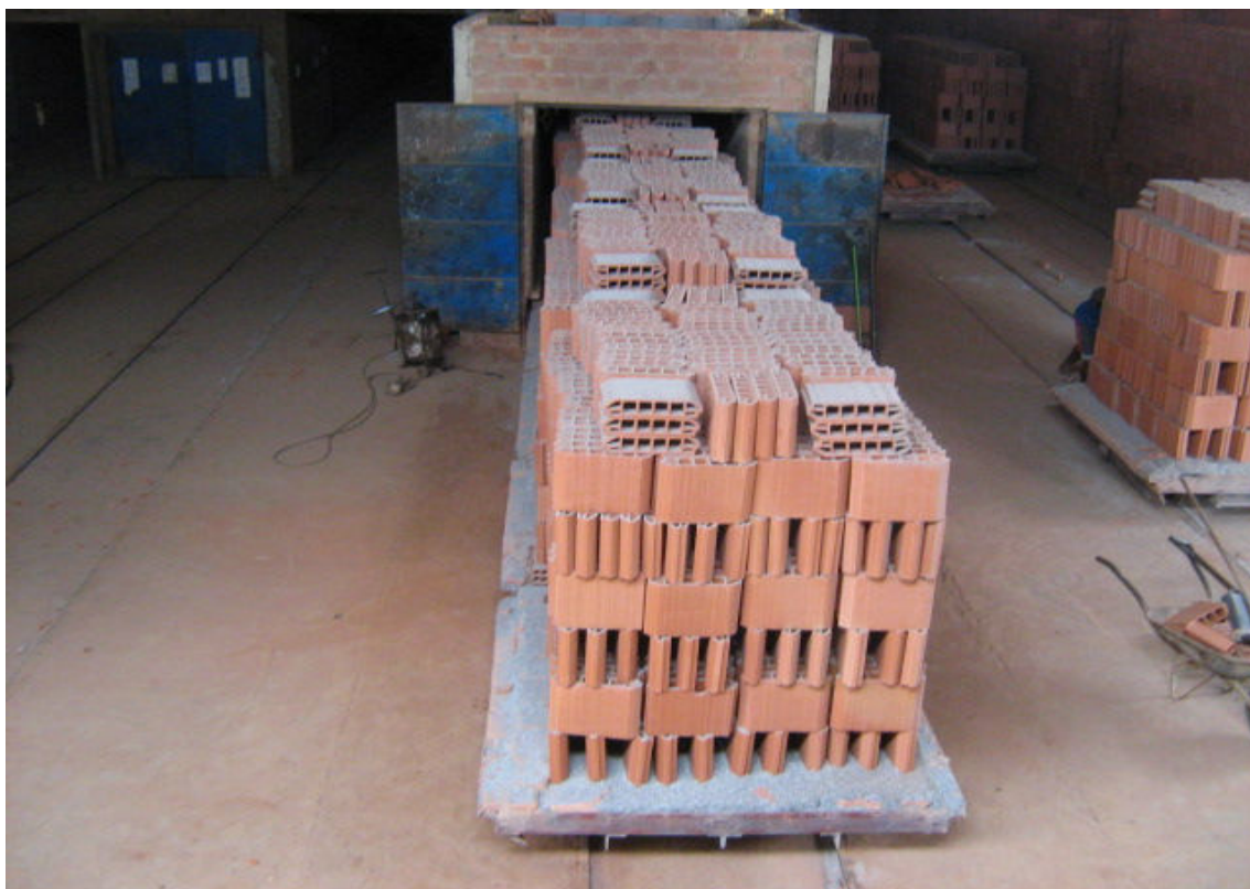
Foto 1: Material pronto alocados em vagonetas saindo do forno túnel
