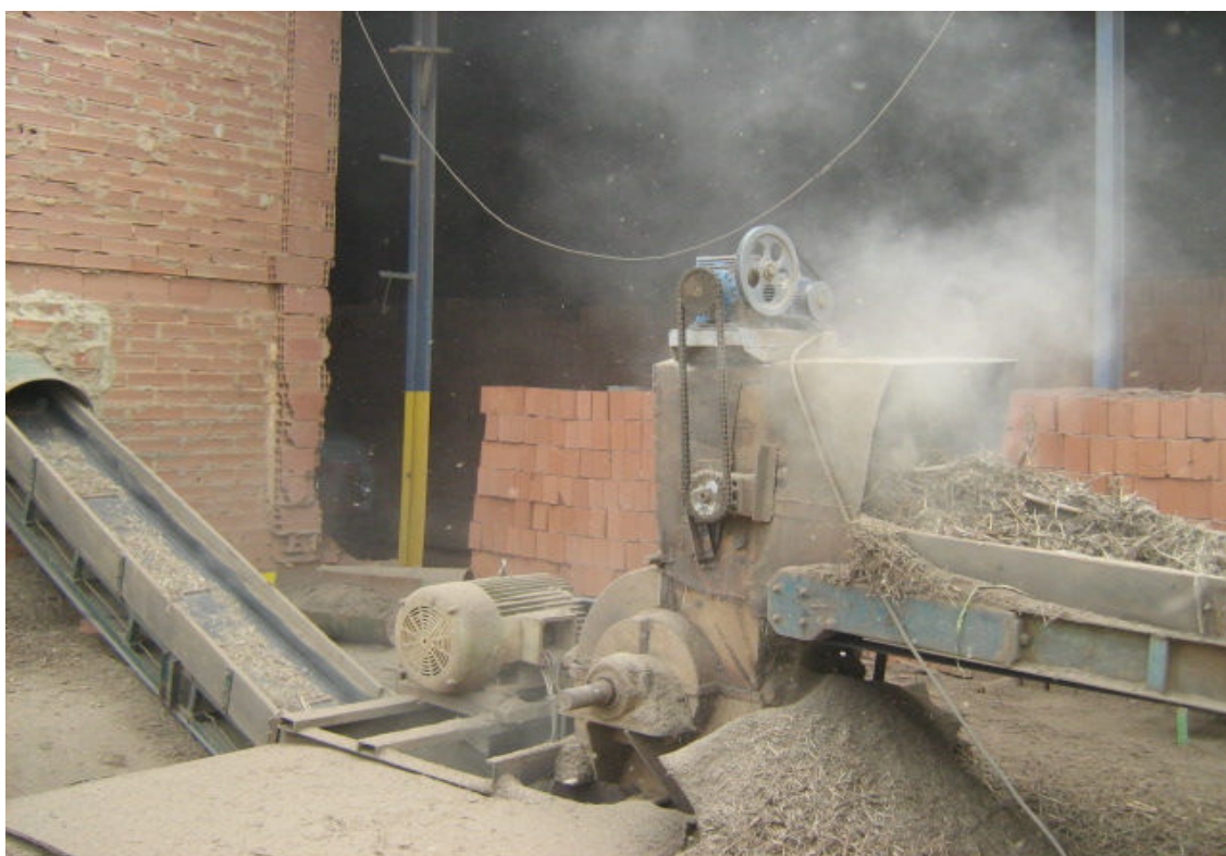
Foto 8: Processo de preparação do Capim Elefante para queima
