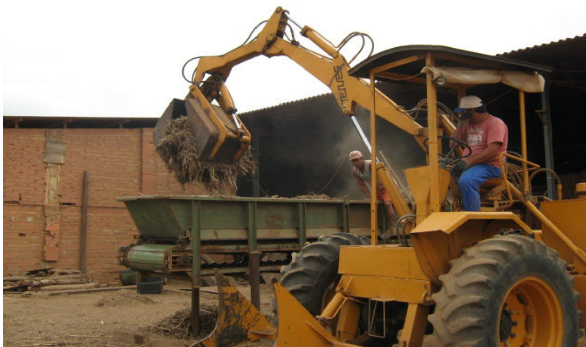
Foto 6: Motocana alimentando o processo de preparação do capim elefante para queima
