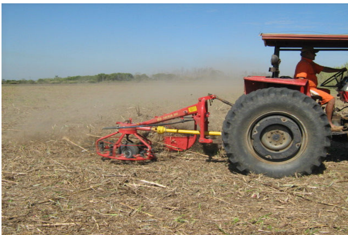
Foto 4: Ancinho enleirador na plantação revirando o capim para secar
