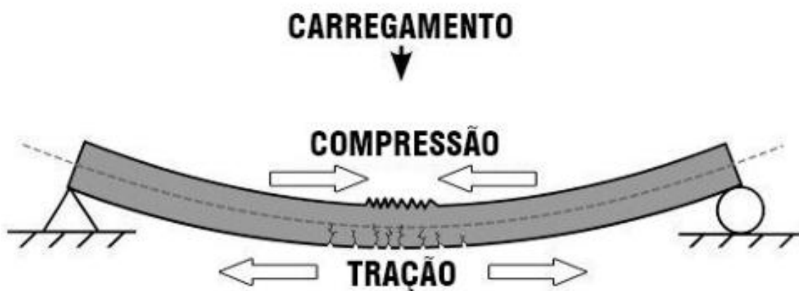
Figura 10 – Esquema de viga sujeita à flexão
