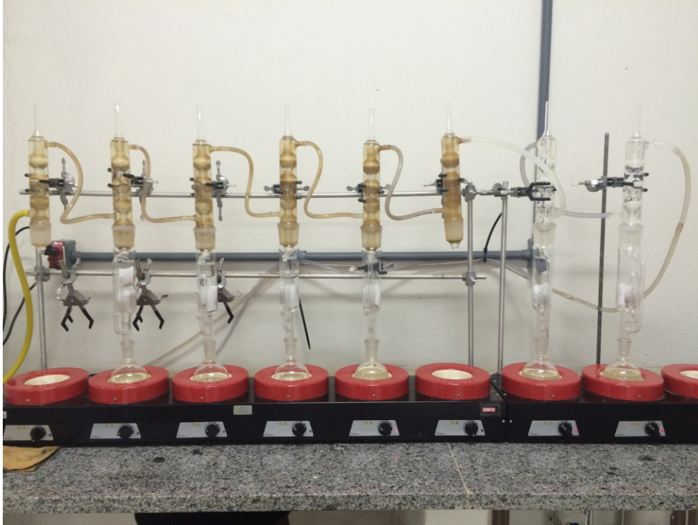
1 2 Figuras 7. Processo de extração da gordura em extrator de Soxhlet Fisatom. (Laboratório de físico- 3 química do IFES Campus Alegre-ES).
