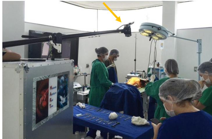
Figura 3. Estação M.A.R.T. acoplada ao gerador de imagem infravermelha sendo utilizada em procedimento cirúrgico na Unidade de experimentação animal (UEA/UENF) (Fonte: Arquivo Pessoal).
