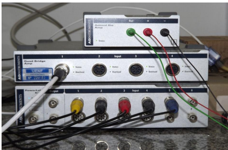
Figura 2. Equipamento BioAmp para análise de pressão arterial média (PAM, mmHg) (Fonte: Arquivo Pessoal).
