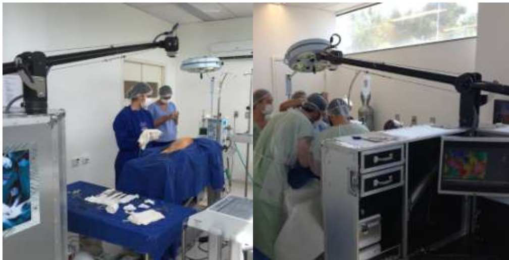
Figura 5 : Estação M.A.R.T. Equipamento de videotermometria acoplado a ilha de trabalho e gerador de imagem.
