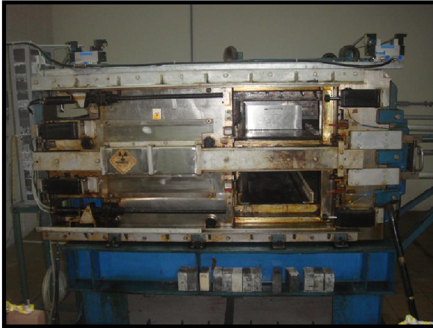
**Figura 2.** Irradiador de pesquisa do CTE<sub>x</sub>, do tipo cavidade blindada, com porta e fonte móveis, utilizado na irradiação das amostras de carne ovina.
