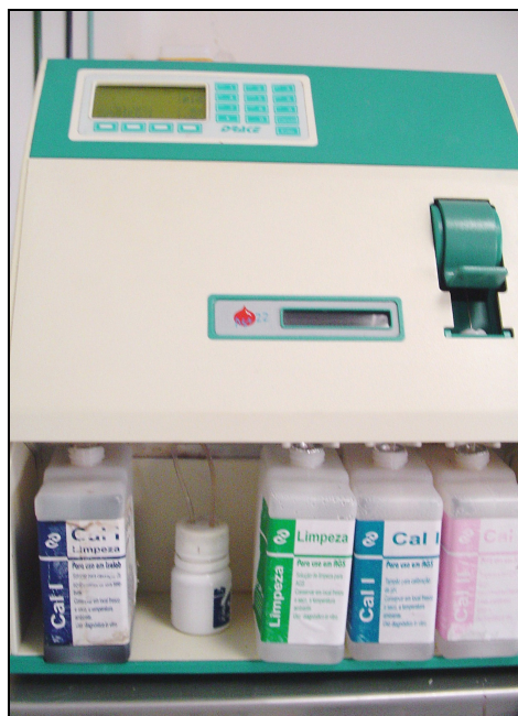
Figura 1: Equipamento de hemogasometria AGS12 utilizado durante a realização de ECMO AV em cães. Hospital Veterinário da Universidade Estadual do Norte Fluminense Darcy Ribeiro. 2008.
