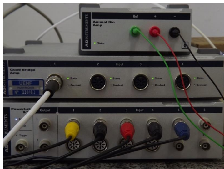
Figura 5: Foto do Equipamento Animal Bioamp 7 da Adinstruments para codificação de pressão arterial e eletrocardiograma acoplado ao tradutor de sinais LabChart Pro 7.3 1 . Fonte: Arquivo pessoal
