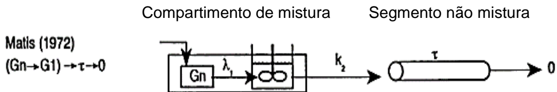
Figura 5. Modelo proposto por Matis (1972) ao fluxo de digesta no ruminante e sua representação por modelos físicos de compartimento de mistura e fluxo de não mistura, adaptado de Ellis et al. (1994)
