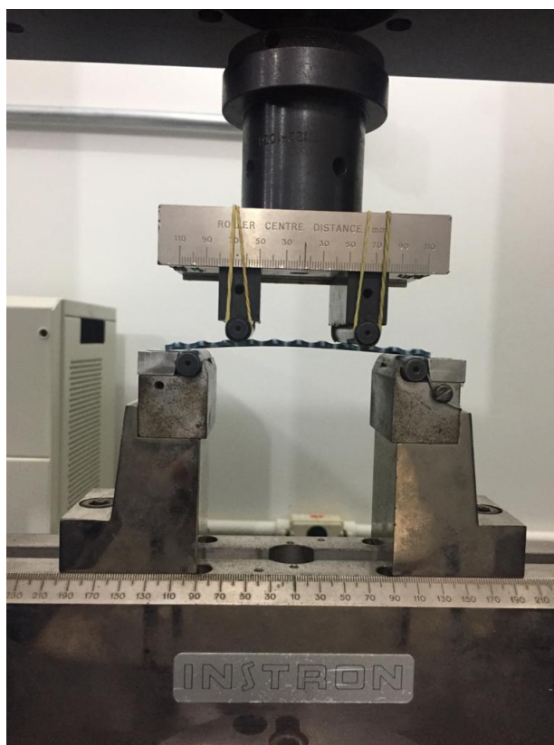
Figura 5: Fonte Arquivo Pessoal - Teste de Flexão em 4 pontos na placa de titânio de 10 mm do grupo 2 na máquina INSTRON modelo 5582, pertencente ao LAMAV.
