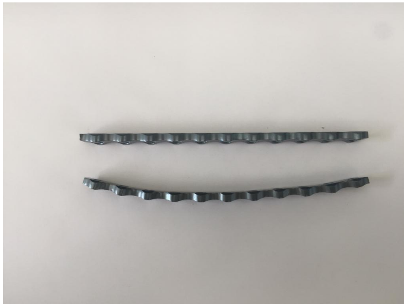
Figura 1: Fonte Arquivo Pessoal - Placas de titânio de 8 mm. A primeira placa (de cima para baixo) pertence ao grupo 1 de placas não moldadas; em seguida a de baixo pertence ao grupo 2 de placas moldadas.
