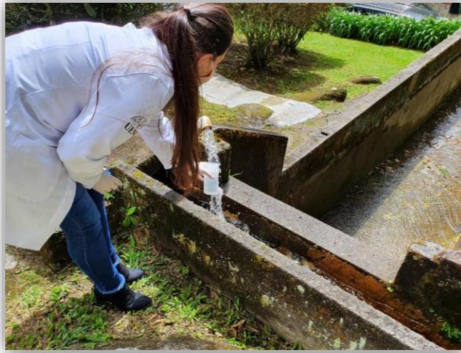
**FIGURA 10:** Coleta de amostra de água de cano de captação para distribuição aos tanques de truticultura ativos, localizados na Truticultura do Vascão em Nova Friburgo – RJ.
