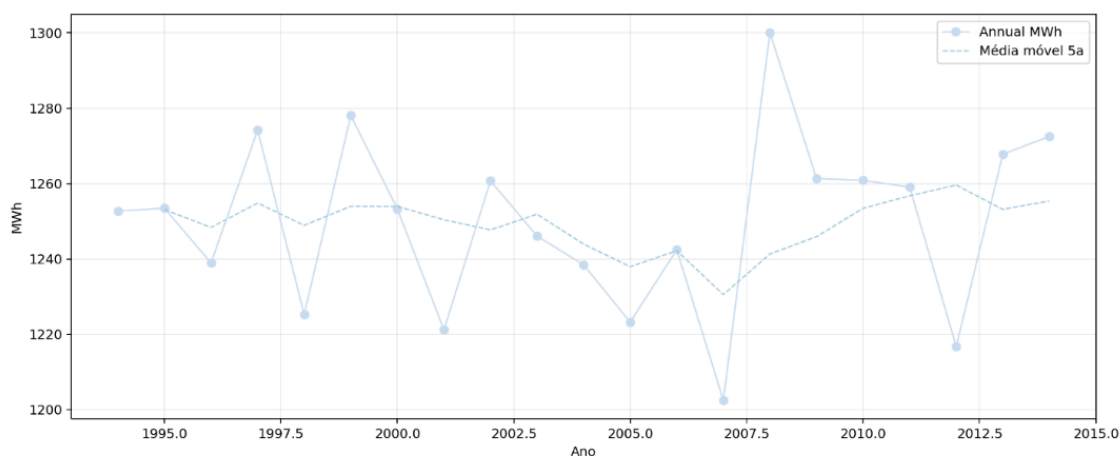
Gráfico 24 – Geração anual de energia (MWh) e média móvel de cinco anos no cenário histórico (1994–2014).
