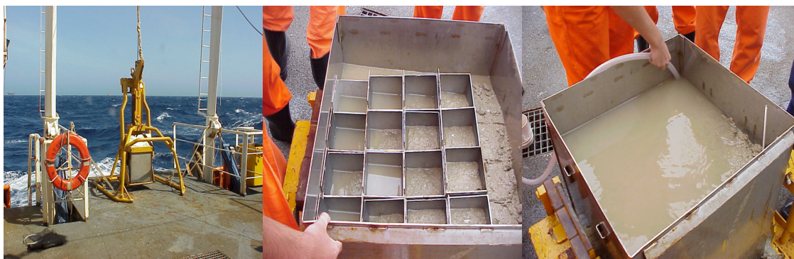
Figura 4. Box-corer utilizado nas coletas de sedimento da Bacia de Campos, litoral norte do Estado do Rio de Janeiro (fonte:Cenpes/ Petrobrás)
