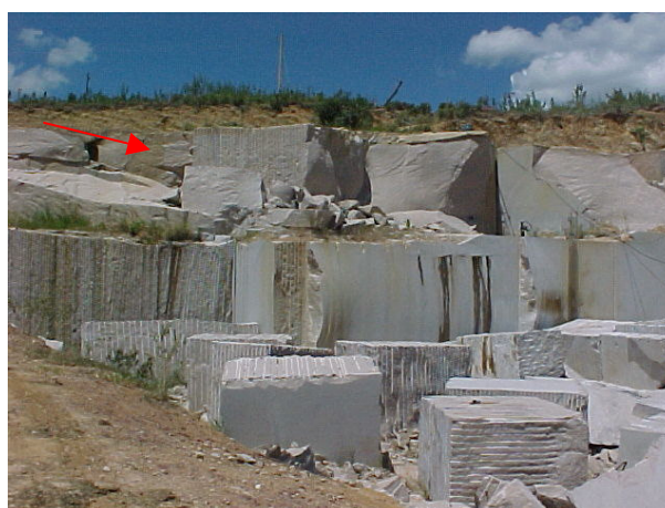
Figura 40: Vista da lavra do leptinito rosa – a seta destaca a fina cobertura de solo. Pedreira Marmoaria Goytacá – Campos dos Goytacazes
