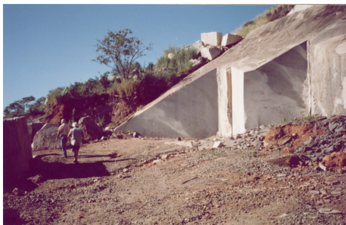
Figura 38: Lavra abandonada devido à mescla de litologias – charnoquito em cinza e leptinito mais claro. Pedreira Itereré Campos dos Goytacazes
