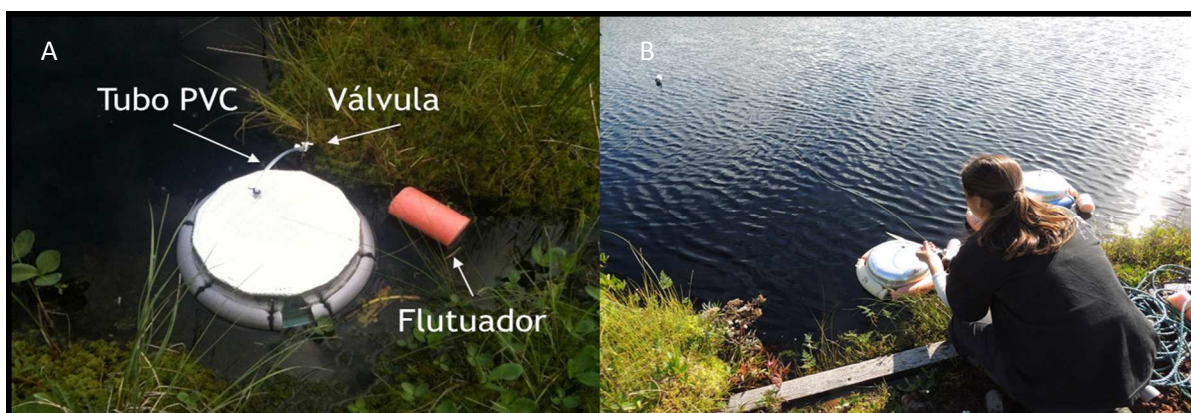
Figura 8. Dispositivos na câmara flutuante (A) e procedimento de amostragem (B).
