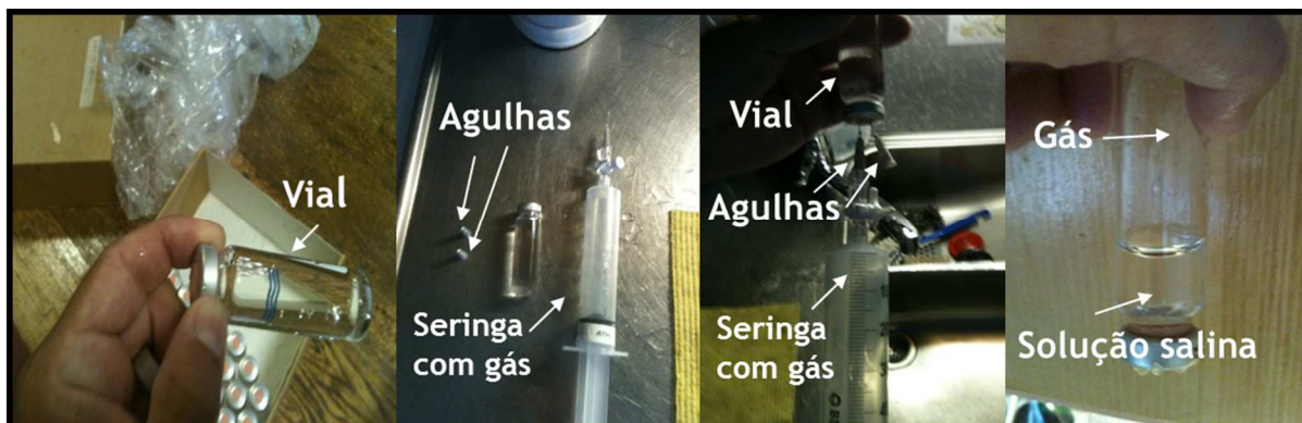
Figura 9. Procedimento de transferência do gás para os vials. Para esclarecimentos, consultar o texto. Fonte: Acervo próprio.
