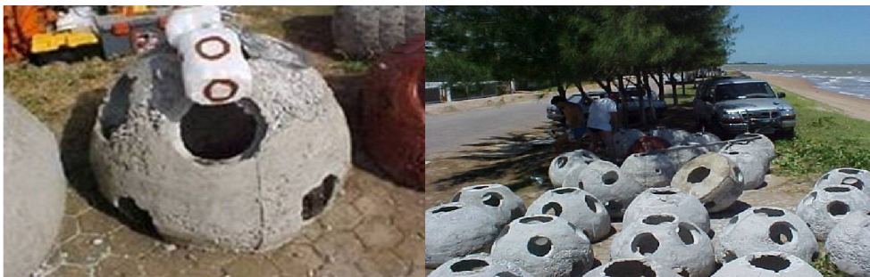
Figura 3. Módulos experimentais de concreto do tipo reef ball .
